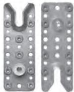
RICON S wird bei statisch hochbelasteten, nicht sichtbaren Haupt- / Nebenträgeranschlüssen im Holzrahmen-, Holzskelett- und Hallenbau eingesetzt. Bei komplett vorgefertigten Raummodulen, Dachgauben und Erkern verkürzt ihr Einsatz die Montagezeit erheblich. Anschlüsse an Stahl, Beton sowie anderen Baumaterialien sind einfach möglich.
