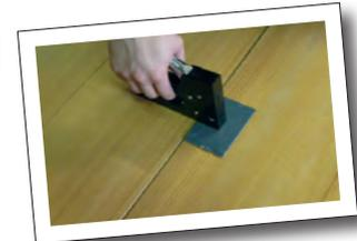
Kraftvolles Gerät aus Metall für die Befestigung von Plastikabdeckungen, Isolationsmaterialien, dünnen Teppichböden auf Holzunterkonstruktionen
