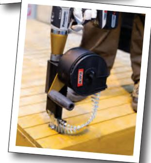
Befestigung von Holz-Platten oder Gipsplatten.
