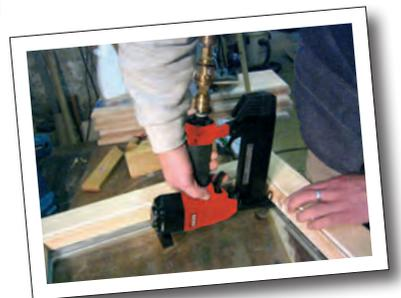
Ausgerüstet mit einem Glaseranschlag für eine unsichtbare Befestigung von Glasleisten
