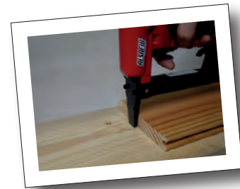
Grâce à son bec de 50 mm de long, cette agrafeuse va dans les endroits difficilement accessibles.
